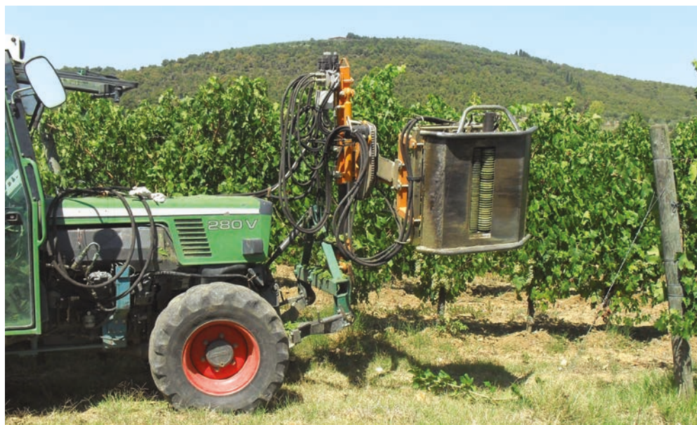
1 - Defogliatrice meccanica a rulli utilizzata nelle indagini sperimentali.
