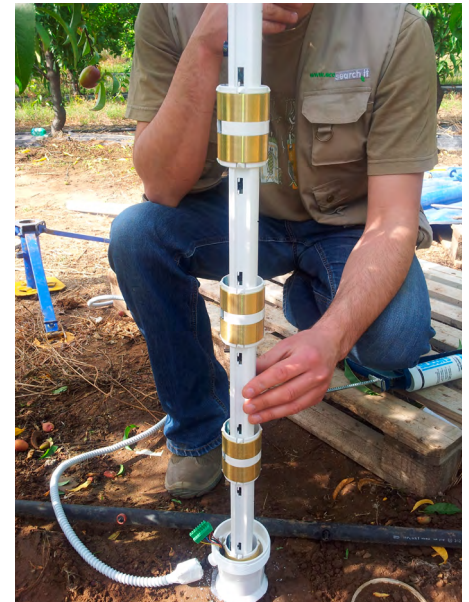
Foto 3 Attraverso l'installazione di apposite sonde nel terreno è possibile monitorare «in tempo reale» la dinamica dell'acqua nel sistema suolo-radice
