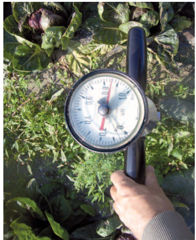
Misurazione in campo della "resistenza alla penetrazione" del terreno (mediante penetrometro manuale).
