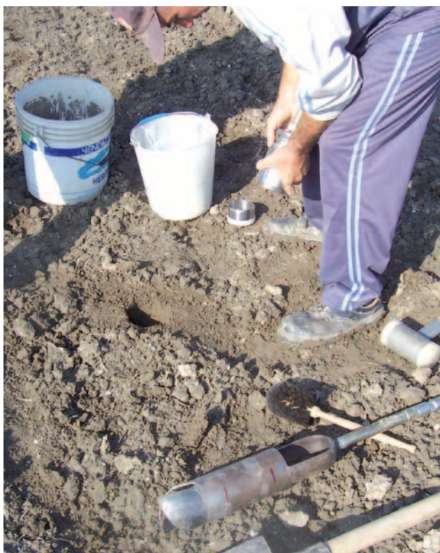
Prelievi di campioni di terreno al centro 'Po di Tramontana' per la stima della densità apparente (metodo del carotatore manuale).
