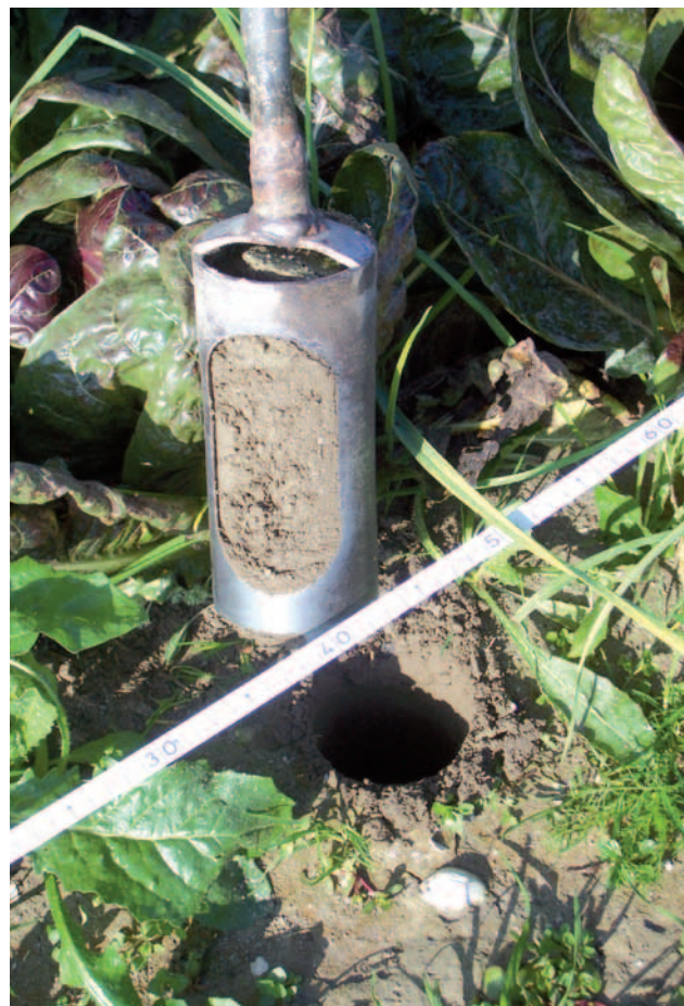
Campionamento del terreno mediante trivella (primo strato fino a 25 cm) per l'analisi delle attività enzimatiche.
