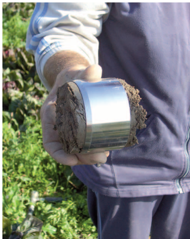
Prelievi di campioni di terreno al centro 'Po di Tramontana' per la stima della densità apparente (metodo del carotatore manuale).
