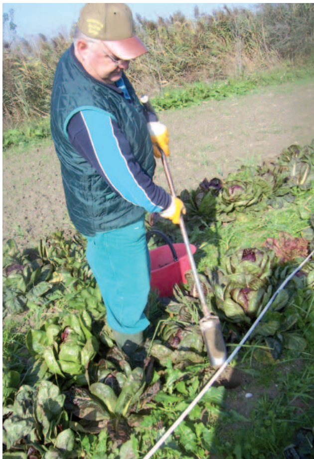
Campionamento del terreno mediante trivella (primo strato fino a 25 cm) per l'analisi delle attività enzimatiche.
