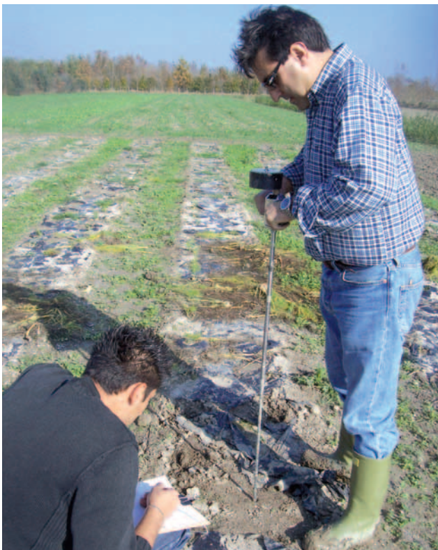
Misurazione in campo della "resistenza alla penetrazione" del terreno (mediante penetrometro manuale).
