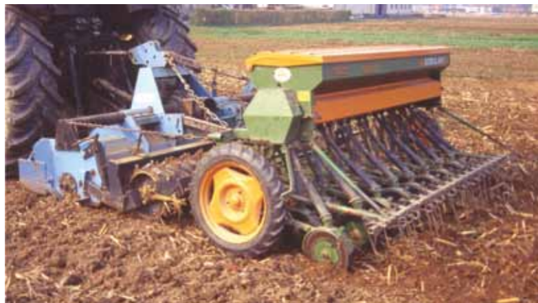
Foto 1: minima lavorazione con combinata erpice a dischi, rullo e seminatrice
